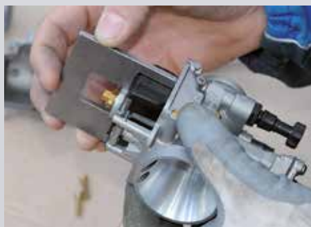
Float level check - Controllo livello galleggiante
